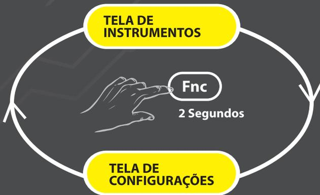
Para abrir o menu de configurações, basta pressionar e manter pressionada a tecla **Fnc** (Funções) até aparecer no display **[CNF]** então solte a tecla e clique novamente sobre a tecla **Fnc** (Funções) para exibir as opções do menu.
