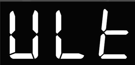
Na função voltímetro [**VLT**], a fonte irá exibir a tensão ajustada através de seu display, podendo ajustar de 2 a 17 volts. Para mudar a função voltímetro, pulse a tecla **Fnc** novamente até chegar no instrumento desejado.
