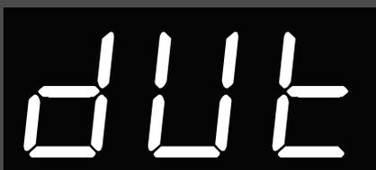
O instrumento Duty Cycle [DUT], é exclusivo para máquinas de bobinas. Para acessar esse instrumento é necessário pulsar **Fnc** até o visor exibir [DUT].
