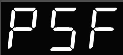
A função pedal sem fio [PSF] permite ou NÃO a conexão com o pedal sem fio Electric Ink (Pedal Bobtail Wireless), através da tecnologia bluetooth.
