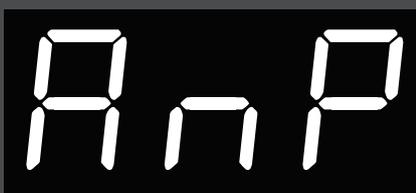
Na função amperímetro [**AMP**], o display exibirá a corrente (Amperes) consumida pela máquina naquele momento. Pulse **Fnc** até aparecer no visor a sigla [**AMP**]. Só aparecerá o valor da corrente quando a máquina estiver ligada, caso contrário o valor da corrente será zero. Esta função é apenas para leitura em qualquer tipo de máquina.
